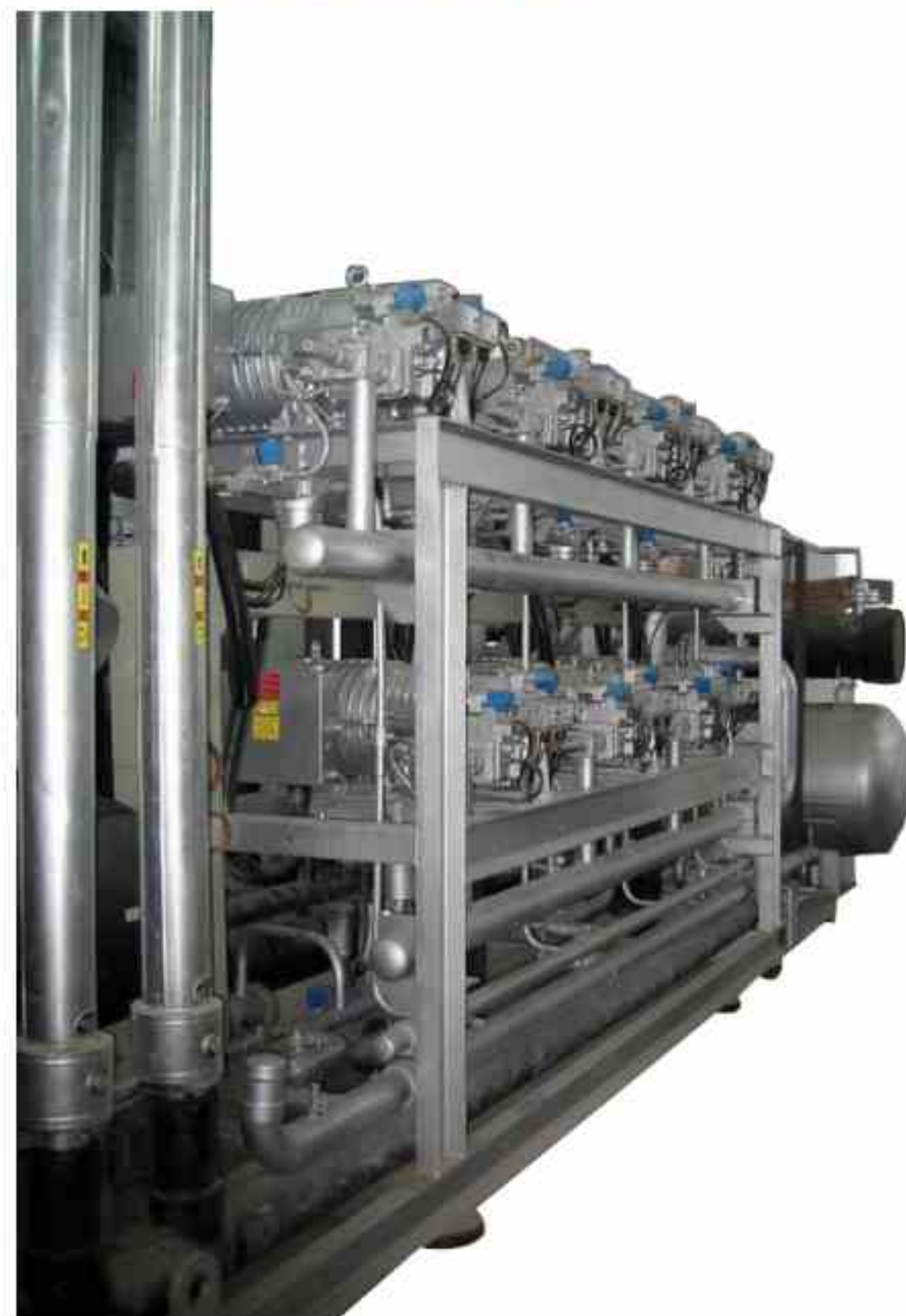
氟利昂系统 Freon Refrigeration System
